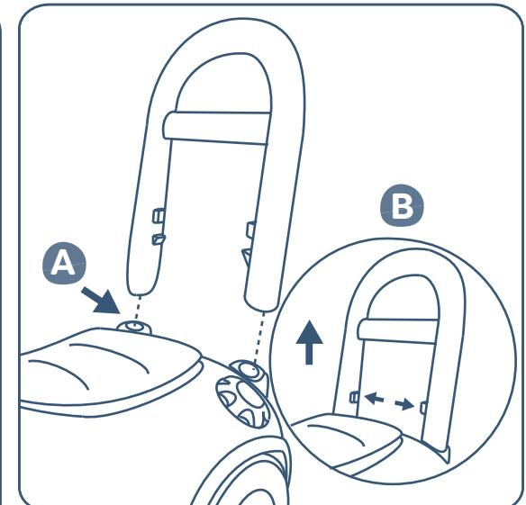
**A** (EN): Insert the handle here! / (FR): Insérez la poignée ici! / (DE): Setzen Sie hier den Griff ein! / (ES): ¡Inserte el mango aquí! / (IT): Inserisci qui la maniglia!
